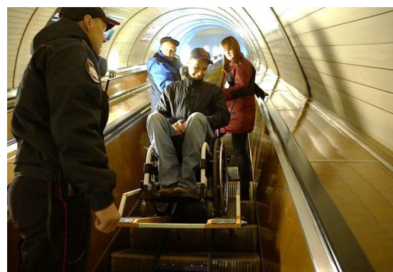
Тележка для транспортировки на эскалаторах метрополитена пассажиров в кресле-коляске
