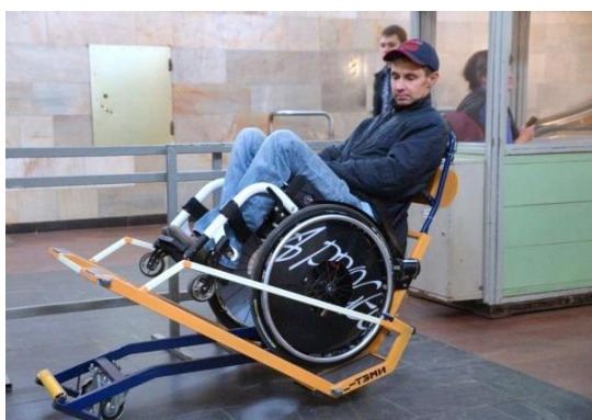
Тележка для транспортировки на эскалаторах метрополитена пассажиров в кресле-коляске
